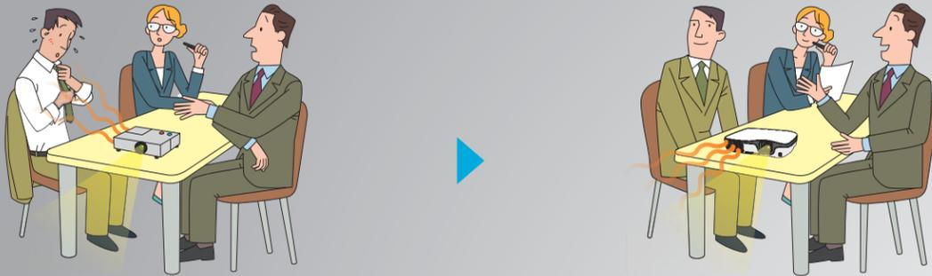
El diseño del proyector impide que los espectadores a su alrededor estén expuestos a la salida del aire caliente aun cuando se encuentre sobre una mesa estrecha.
