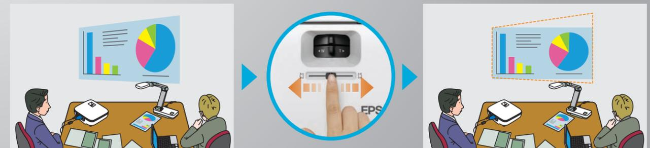
Las correcciones horizontales de la pantalla pueden hacerse rápida y fácilmente desplazando la barra deslizante hacia la izquierda o la derecha. El ajuste intuitivo de la pantalla es una función muy útil tanto para el usuario principiante como para el más experimentado. Gracias a estas funciones, no es necesario colocar el proyector en el centro del escritorio y podrás colocarlo donde prefieras.
