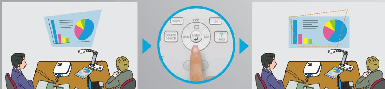
Estos proyectores permiten realizar la corrección trapezoidal vertical (automática / manual) y horizontal (manual). La corrección vertical de pantalla se hace automáticamente.
